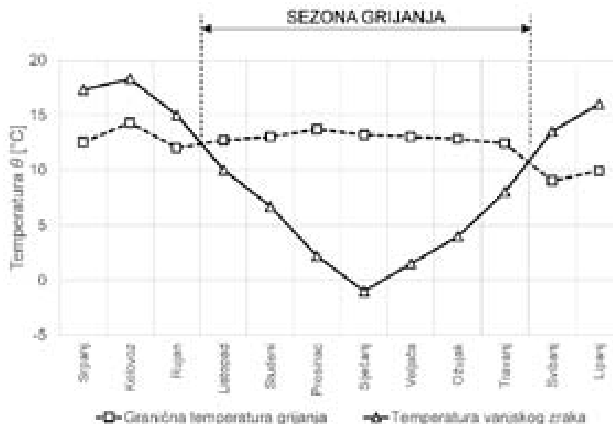
Slika 6.8 Utvrđivanje trajanja sezone grijanja usporedbom granične temperature grijanja i temperature vanjskog zraka
