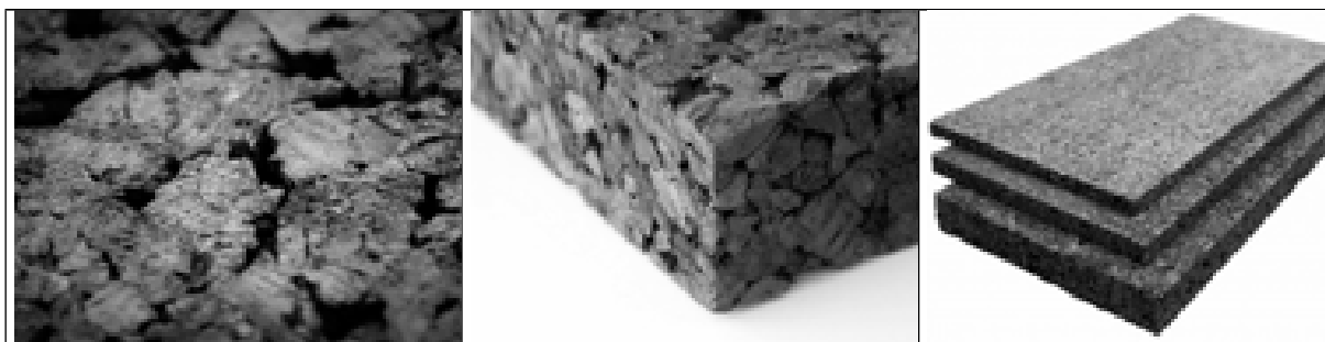
Slika 3.19 Struktura ploča od pluta [160], detalj ruba ploče od pluta [161], ploče od pluta [162]
