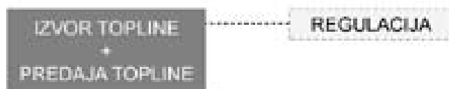
Slika 7.1 : Shematski prikaz strukture sustava lokalnog grijanja
