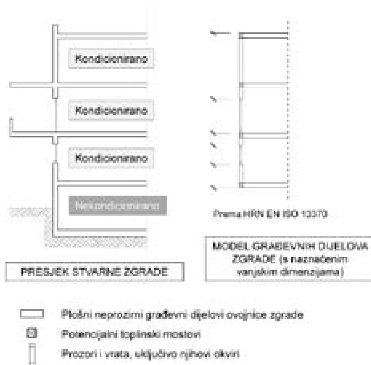
Slika 6.13 Modeliranje ovojnice zgrade za proračun koeficijenta prijenosa topline transmisijom.
