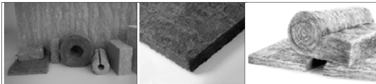
Slika 3.26 Proizvodi od kamene vune [175], ploče od kamene vune proizvedene ECOSE tehnologijom [176], blazina od staklene vune proizvedena ECOSE tehnologijom [176]
