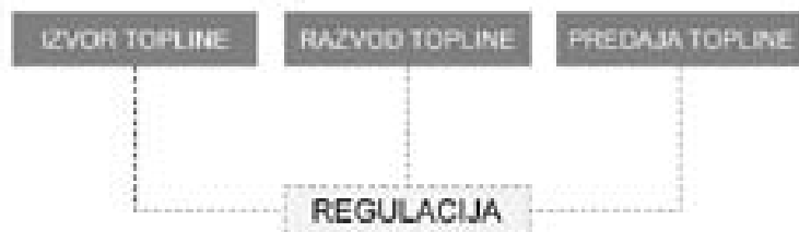
Slika 7.2 : Shematski prikaz strukture sustava toplovodnog centralnog grijanja
