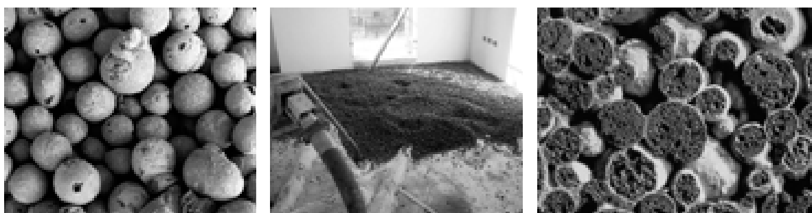
Slika 3.15 Granule ekspandirane gline [150], nasip granula ekspandirane gline [151], lagani beton s ekspandiranom glinom [152]
