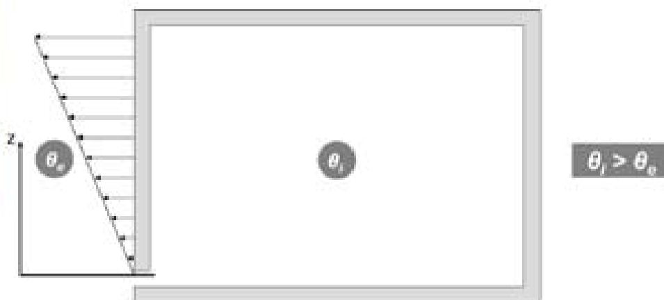
Slika 5.13 Promjena hidrostatskog tlaka u prostoriji koja je potpuno nepropusna za zrak, osim jednog otvora u razini poda, vertikalni presjek
