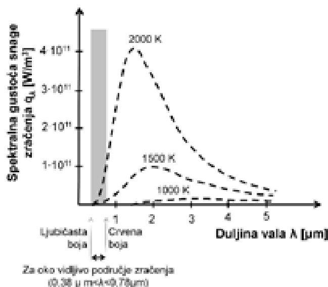
Slika 2.10 Spektralna gustoća snage zračenja, q_\lambda , crnog tijela u ovisnosti o duljini vala zračenja, \lambda , i termodinamičkoj temperaturi, T , [25]
