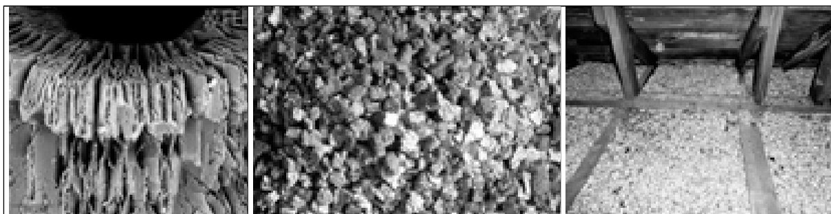
Slika 3.18 Mikroskopska slika strukture ekspandiranog vermikulita [158], granule ekspandiranog vermikulita [159], nasip granula ekspandiranog vermikulita [159]
