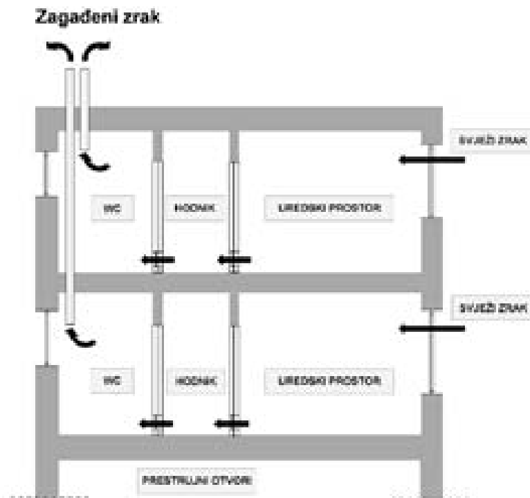
Slika 7.21 Princip prirodne ventilacije
